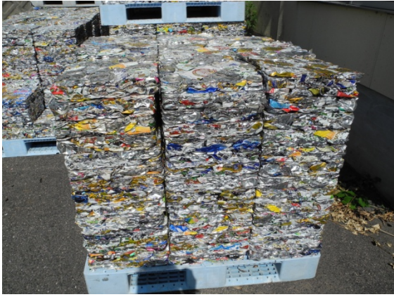
島内で収集されたアルミ缶はプレスされ年に1度島外のリサイクル業者が回収します。
