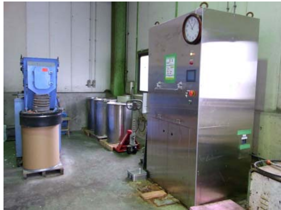
発泡スチロールゲル化処理機 (左: 蛍光灯破砕機)
