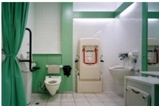
聖蹟桜ヶ丘ショッピングセンター2階の「だれでもトイレ」広さは2.4m×2.4m。オストメイト用の汚物流し、シャワーヘッド付蛇口、着替え台、大人も使えるオムツ替え用ベット、介助者待機用カーテン等がついていて、改定ハートビル法の誘導基準にも交通バリアフリー法の望ましい基準にもクリアしている。（設計・写真提供：設計事務所ゴンドラ）
